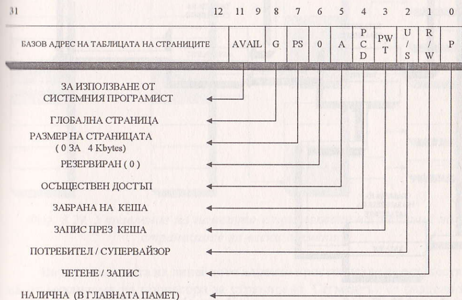
Фиг. 3.27. Съдържание на таблицата на каталозите на страниците, (една позиция) при размер на страницата 4 Kbytes
