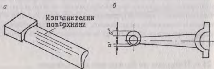
Фиг.21.11. Изисквания за взаимно разположение на обработени и необработени повърхнини
