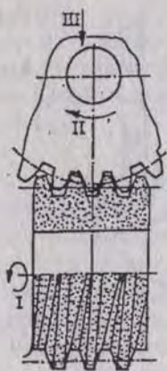
Фиг.11.12. Зъбошлифоване с абразивен червяк
